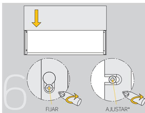
Repetir los pasos 4, 5, 6 para montaje de la puerta inferior.
